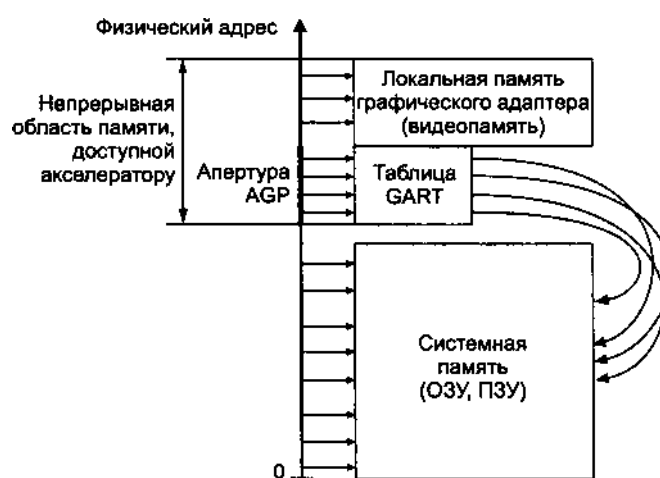
Рис. 10.3. Адресация памяти в системе с AGP
