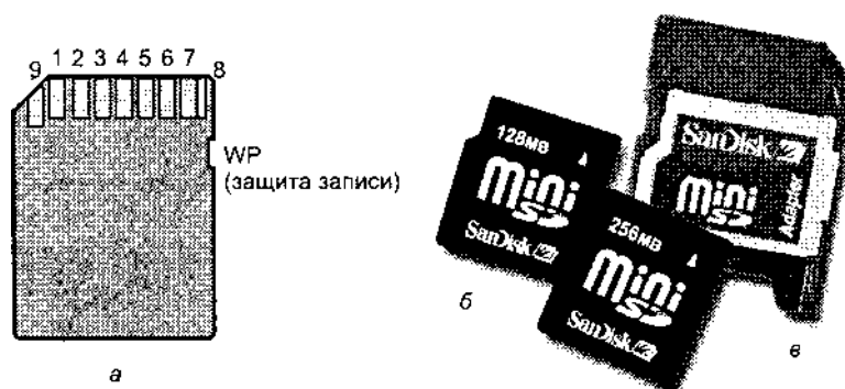
Рис. 9.17. Карты SD: а — обычная (вид сзади), б — MiniSD, в — адаптер
