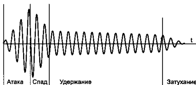
Рис. 12.5. Типовая осциллограмма звука фортепиано
