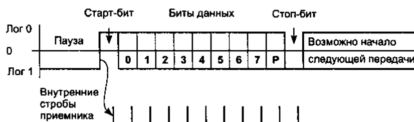
Рис. 16.2. Формат асинхронной передачи
