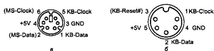
Рис. 11.1. Разъемы подключения клавиатур (вид со стороны контактов): а — PS/2, б — АТ
