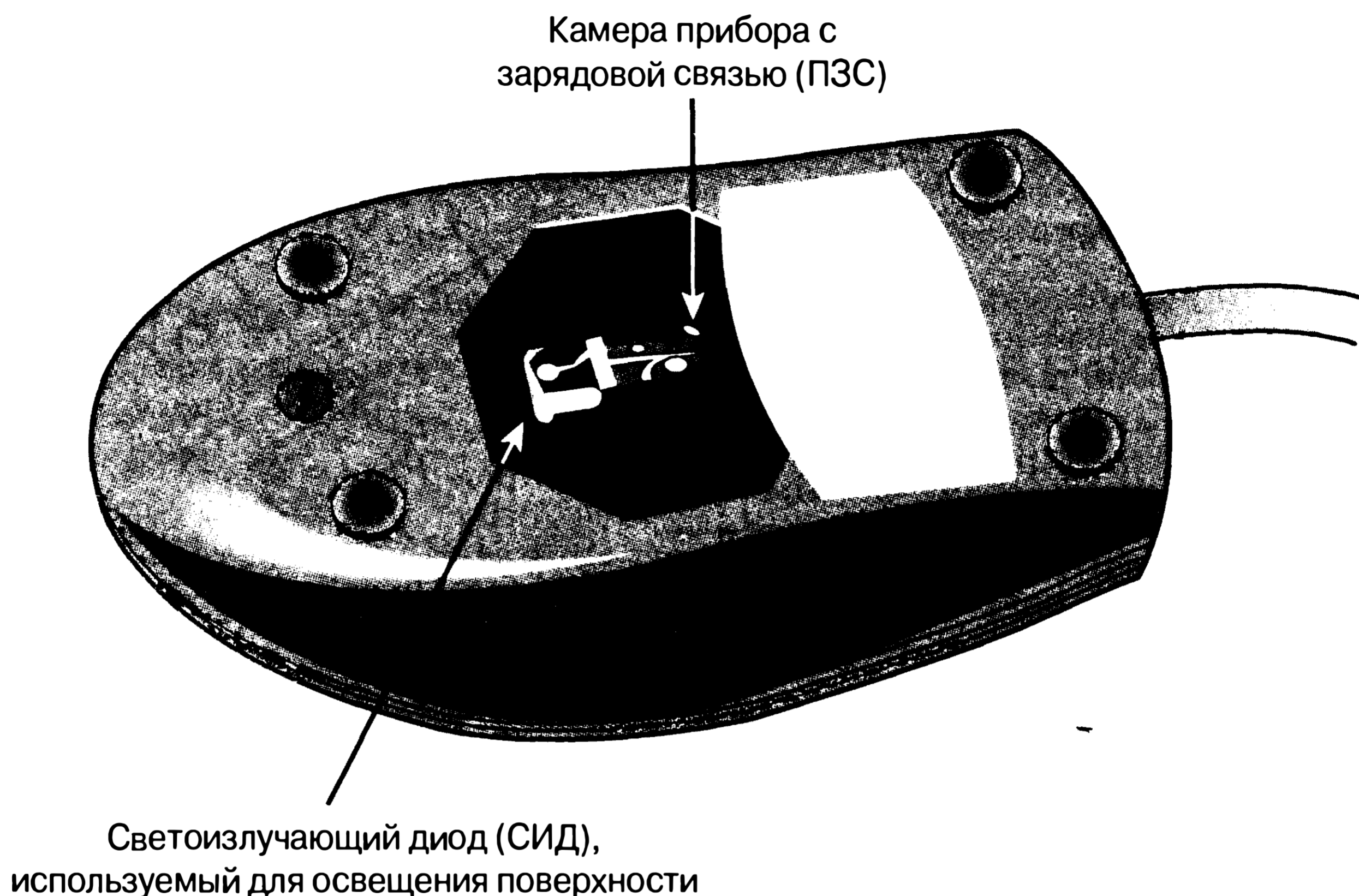
Рис. 15.11. Оптическая мышь Logitech iFeel (вид снизу)
