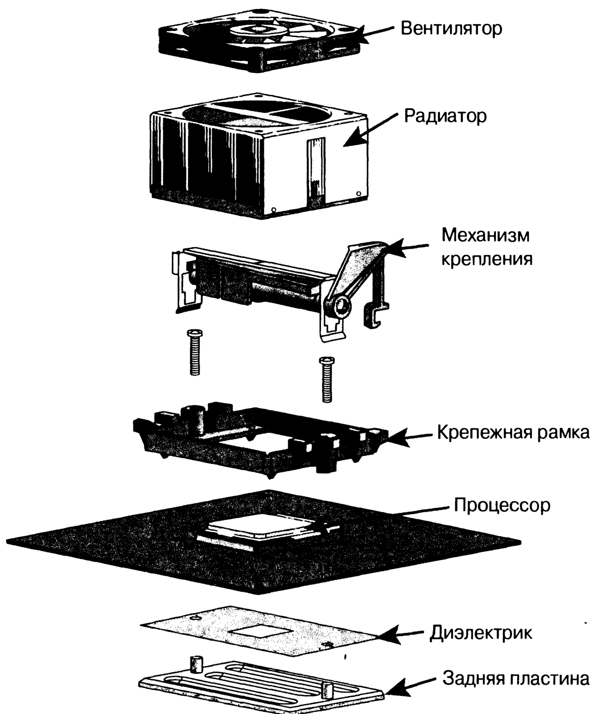
Рис. 3.56. Активный радиатор, предназначенный для охлаждения процессоров Athlon 64, Athlon 64 FX и Opteron. Подходит для процессоров, устанавливаемых в разъемы Socket 754, Socket 939 и Socket 940
