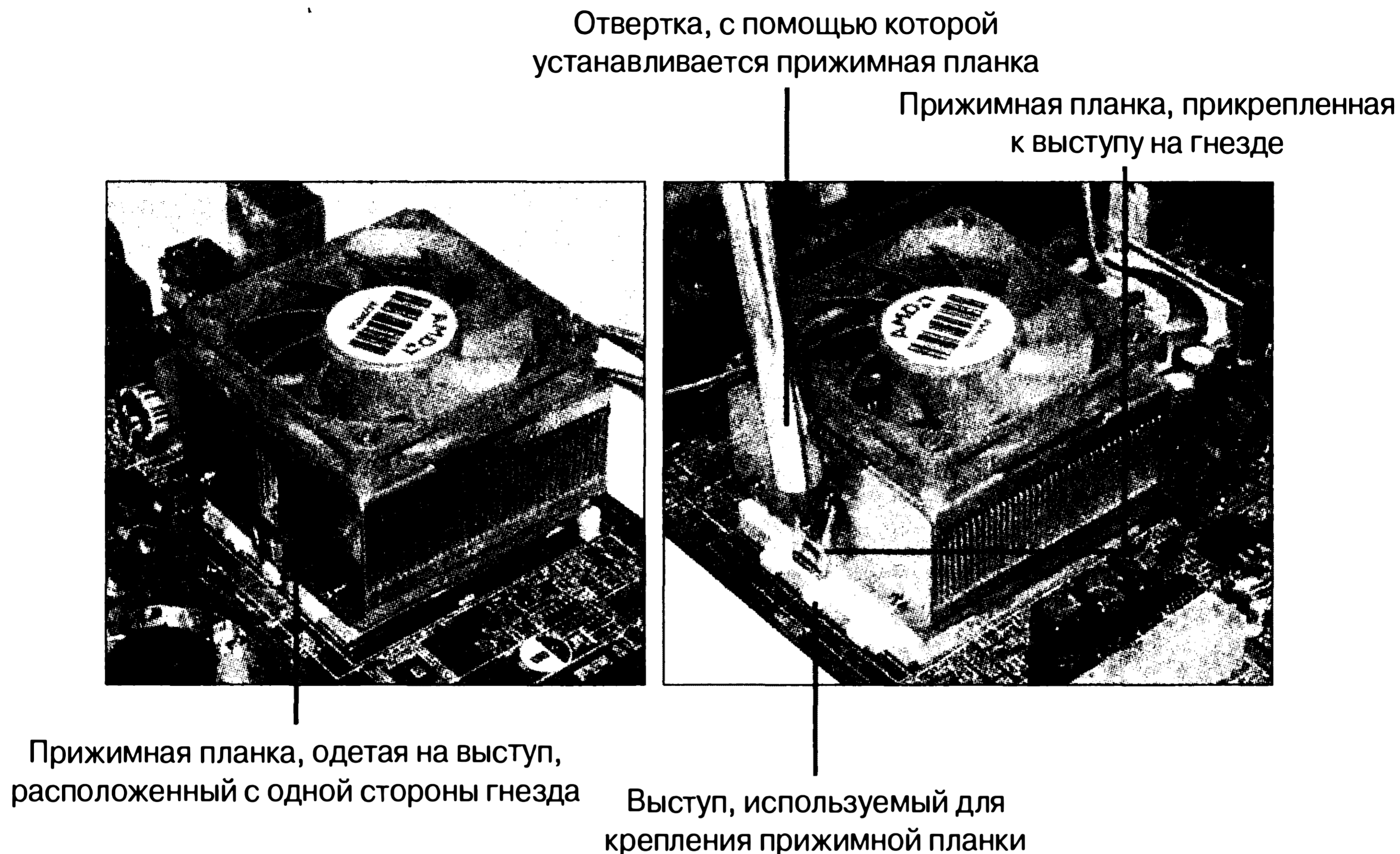
Рис. 19.5. Установка радиатора на процессор гнездового типа. В этой конструкции используется пружинная прижимная планка, поэтому ее следует устанавливать в заданное положение с помощью отвертки или другого подобного инструмента, которым можно надавить на планку и зацепить ею нужный выступ
