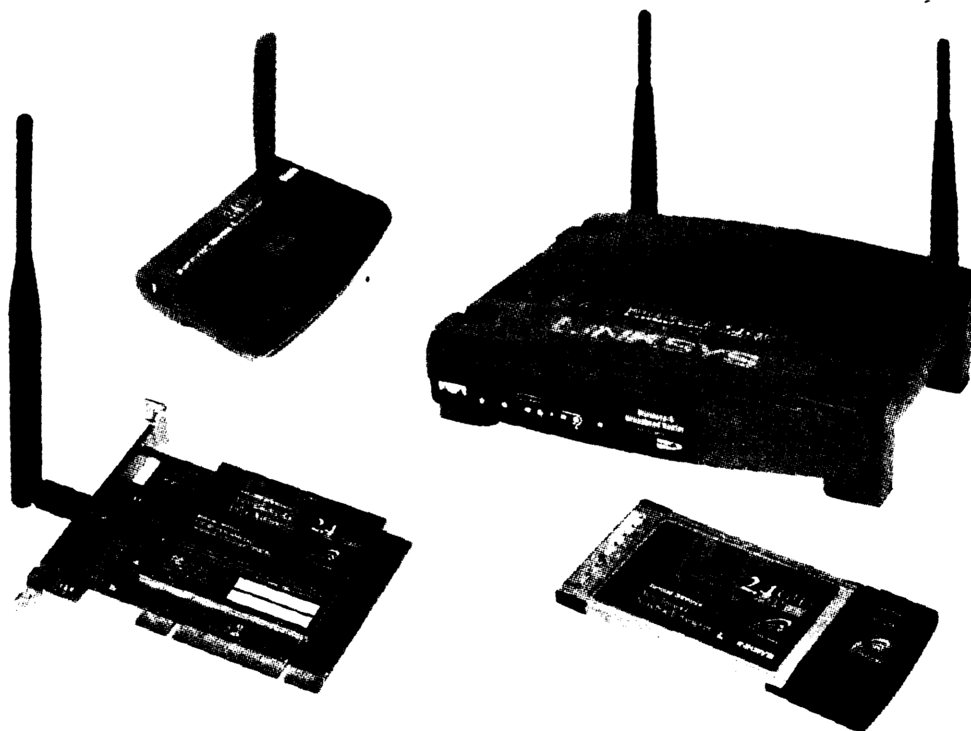
Рис. 17.20. Типичное семейство продуктов стандарта Wi-Fi с частотой 2,4 ГГц включает в себя беспроводный маршрутизатор и сетевые адаптеры USB/PC Card/PCI
