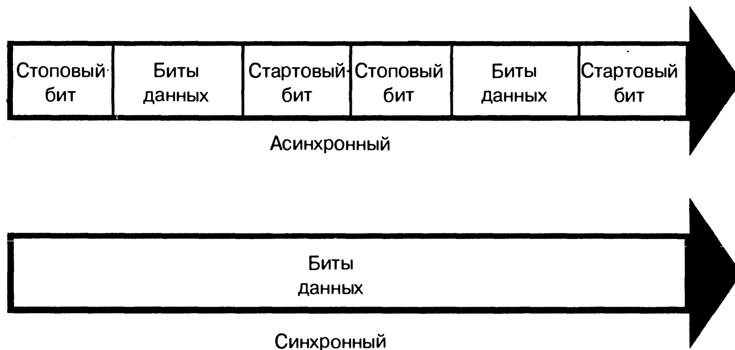
Рис. 16.5. В асинхронных модемах при передаче одного байта данных добавляются стартовые и стоповые биты, а в синхронном соединении данные передаются непрерывным потоком
