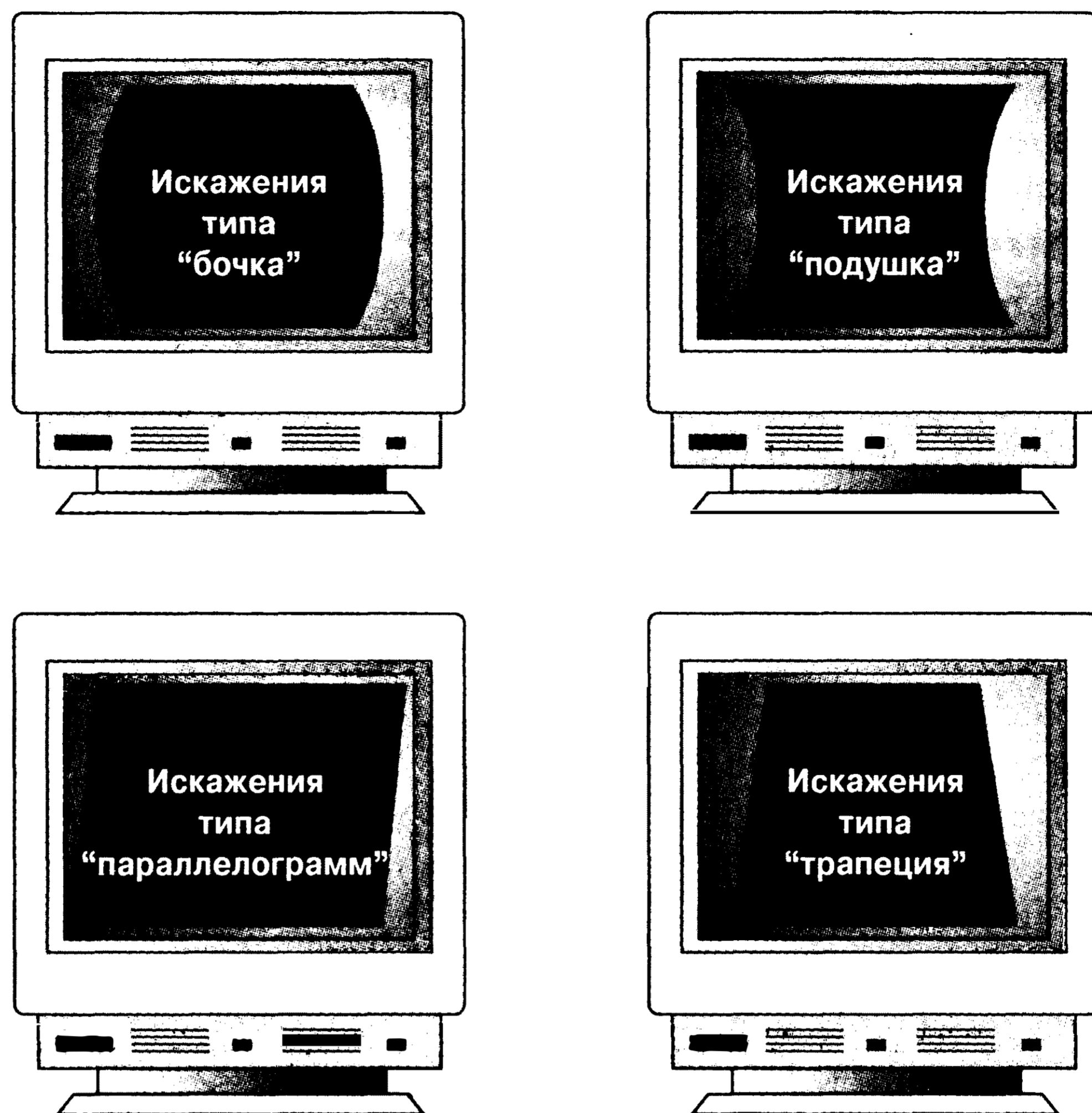
Рис. 12.25. Современные модели мониторов, как правило, поддерживают настройку нескольких параметров геометрии изображения
