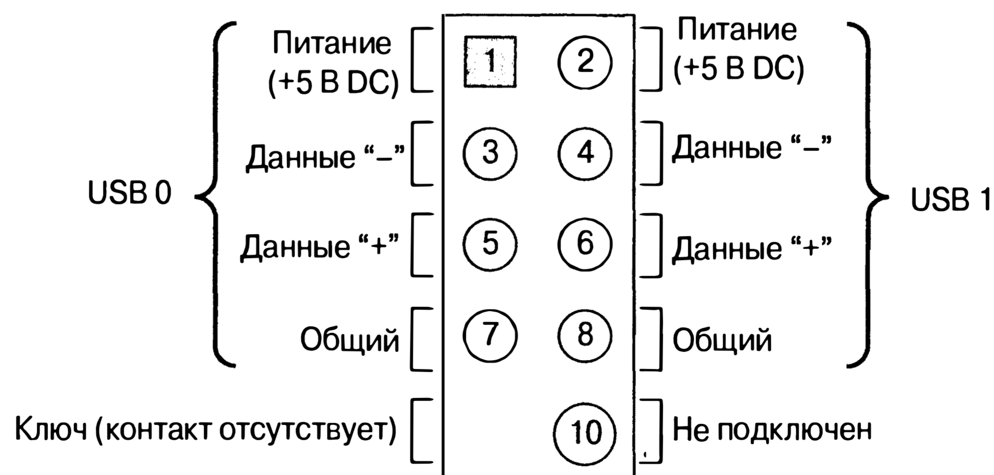
Рис. 4.33. Схема размещения контактов стандартного разъема для подключения двух портов USB
