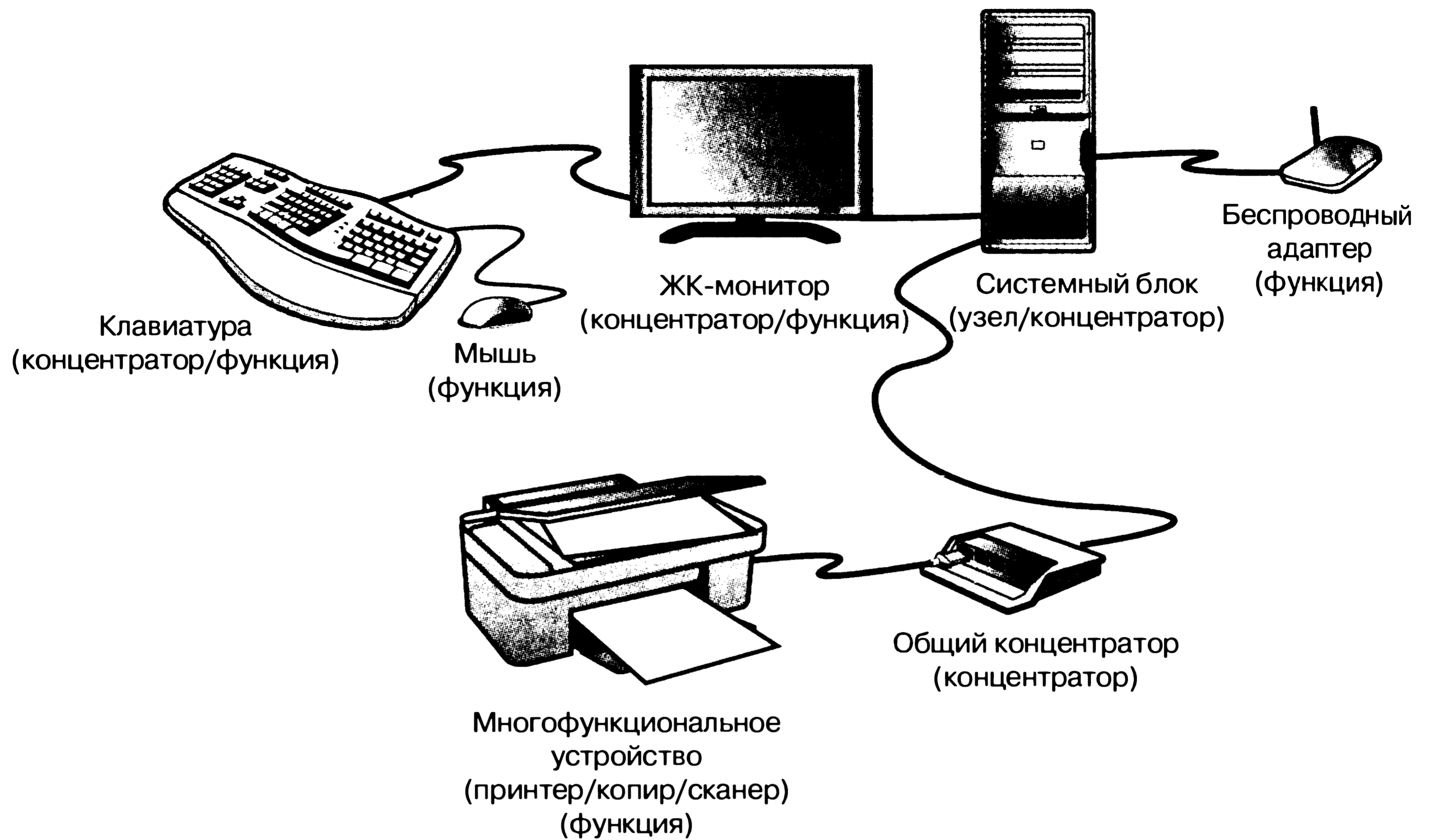
Рис. 14.4. В компьютере может использоваться несколько концентраторов USB для подключения различных периферийных устройств, причем любое устройство можно подсоединить к любому концентратору
