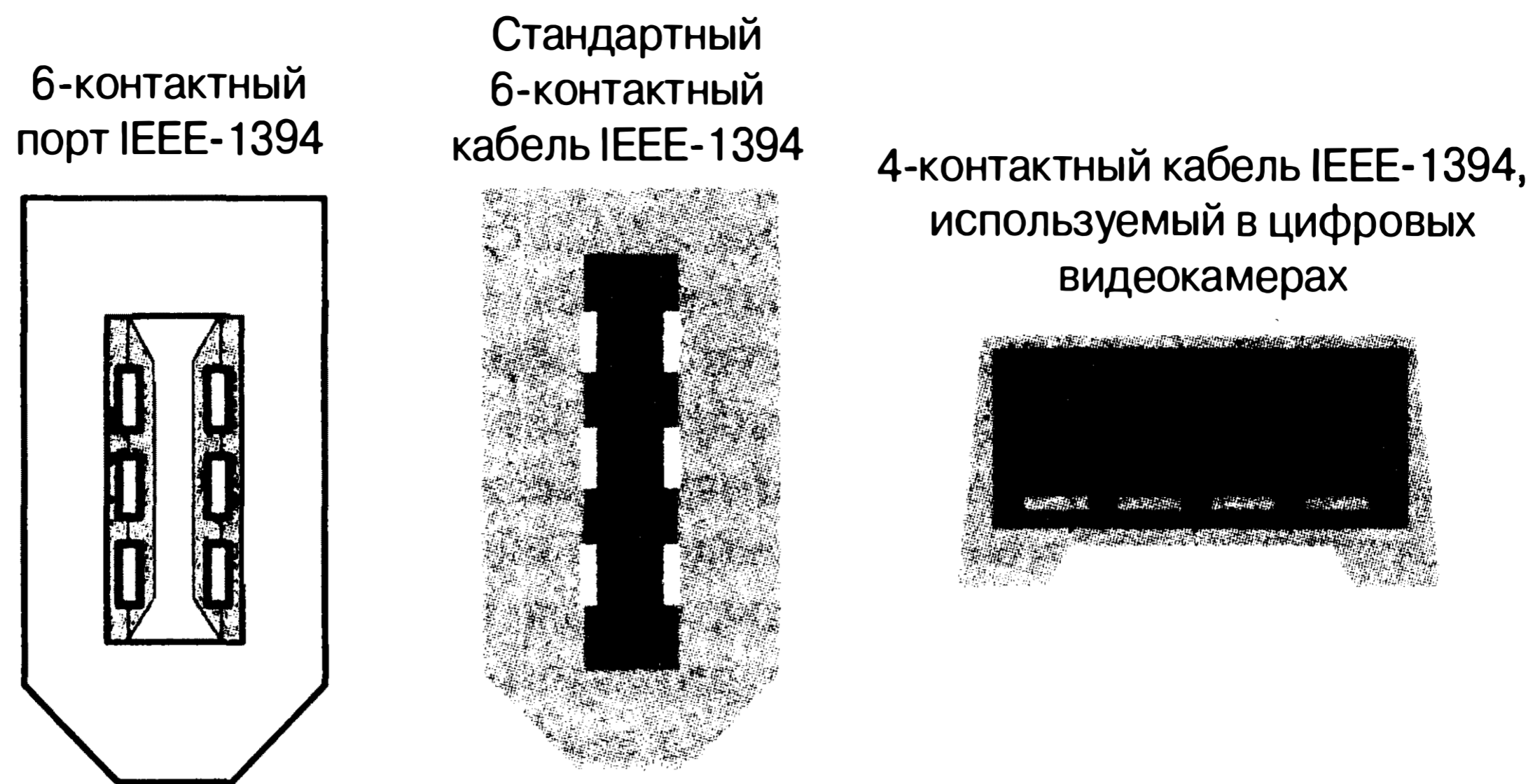
Рис. 14.15. Кабель, разъемы и соединитель шины IEEE 1394
