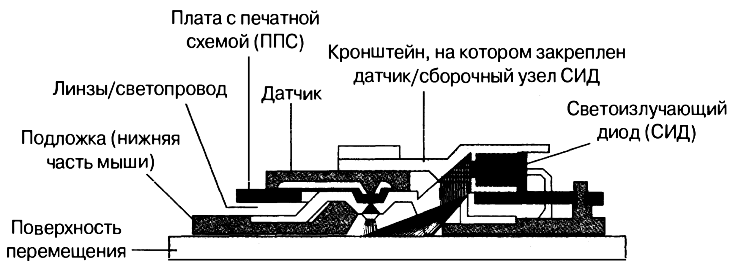
Рис. 15.12. Светоизлучающий диод, находящийся внутри оптической мыши, освещает поверхность, посылая импульсы света несколько раз в секунду. Свет, отражаемый от поверхности (будь то стол или коврик мыши), улавливается датчиком, который преобразует информацию в цифровые данные и передает их компьютеру
