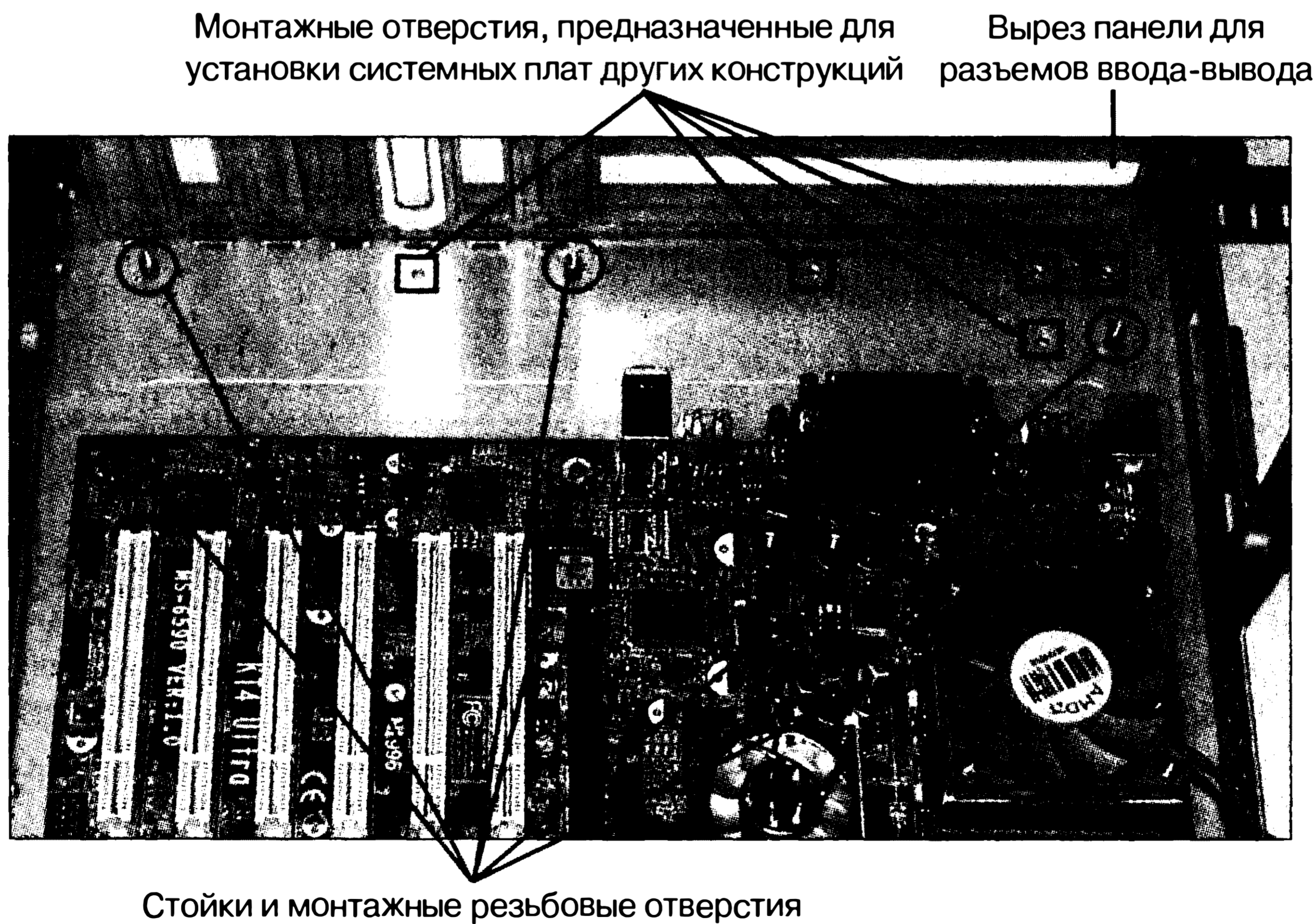
Рис. 19.9. Проверьте, совпадают ли стойки с отверстиями на системной плате. Обратите внимание на то, что на шасси имеется множество монтажных отверстий, которые позволяют устанавливать в корпусе системные платы самых разных конструкций
