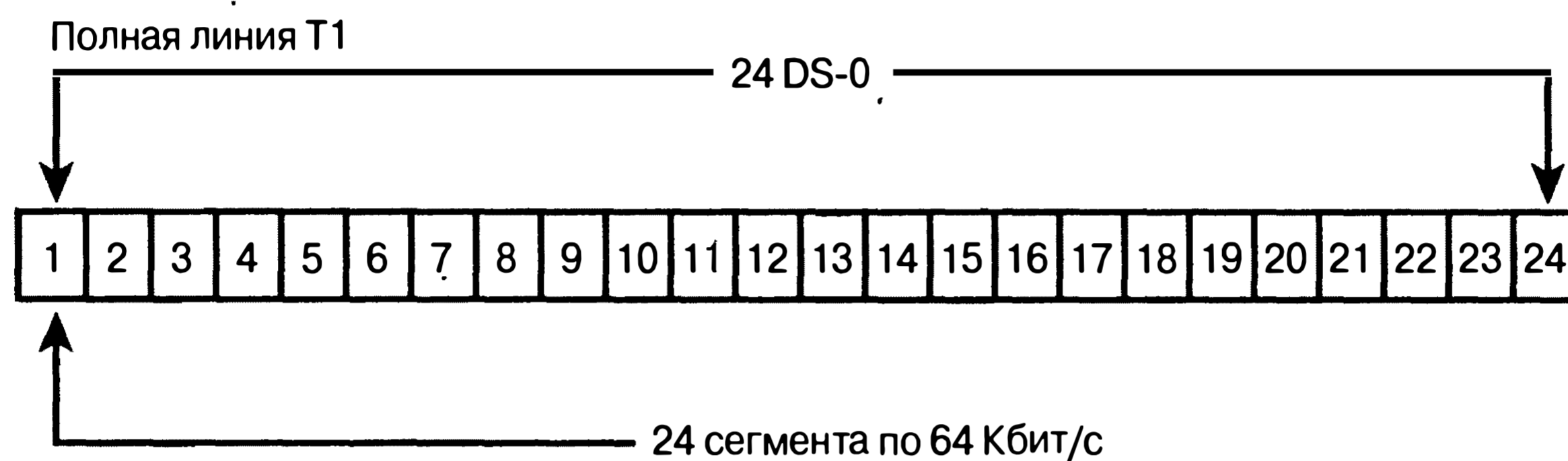
Рис. 16.4. Схема возможного разделения канала T-1
