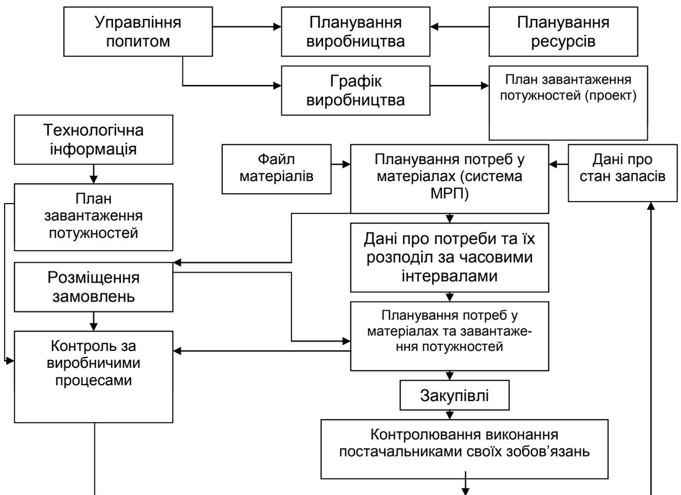
**Рис. 27 Функціональна схема системи МРП-2**
