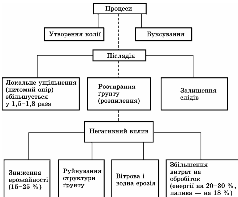
Рис. 19. Схематичне зображення пекідливої дії ходових систем сільськогосподарських машин на ґрунт
