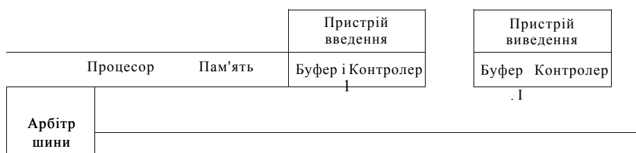
Рис. 1.8. Одношинна структура комп'ютера
