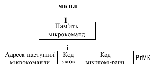
Рис. 8.17. Пам'ять макрокоманд з регістром адреси мікрокоманди на вході та регістром мікрокоманди на виході
