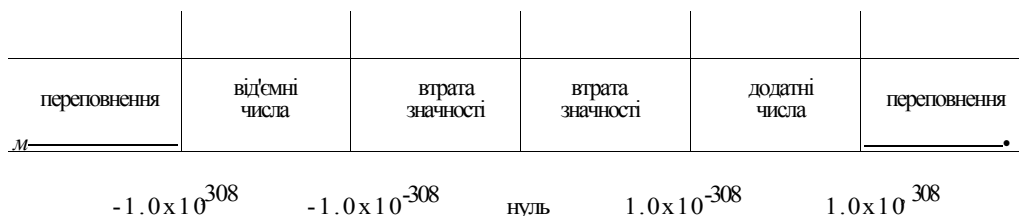
Рис. 2.15. Діапазон чисел, які відображаються у форматі за стандартом IEEE-754 з подвійною точністю
