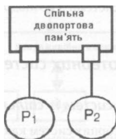
Рис. 12.18. Система із спільною пам'яттю з двома портами
