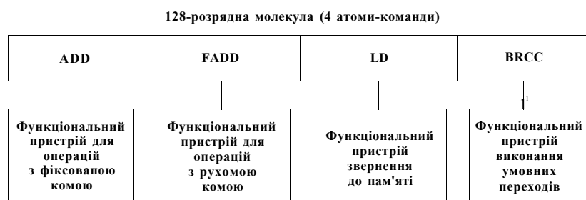
Рис. 5.28. Загальна структура ядра процесора Crusoe
