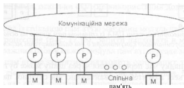
Рис. 12.20. Система NUMA із спільною пам'яттю
