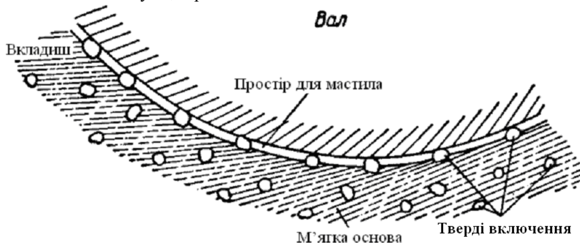
Рис. 18.25. Поверхня розділу вкладиш — вал [13]
