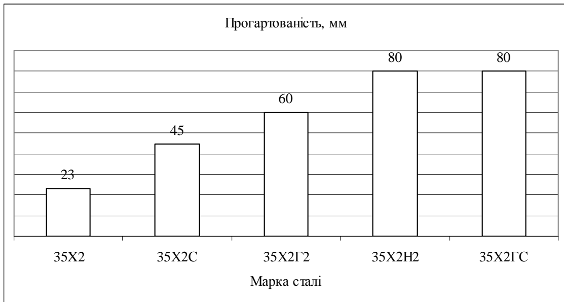
Рис. 15.6. Вплив легування на прогартованість сталей
