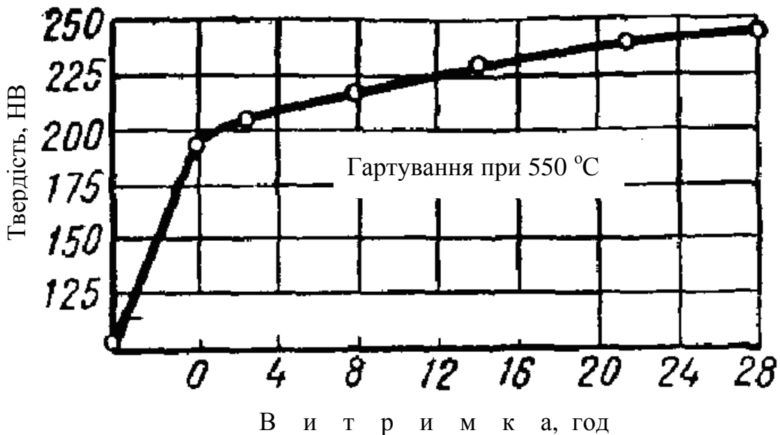
Рис. 12.19. Твердість азотованого електролітичного заліза після загартування і вилежування при кімнатній температурі [16]
