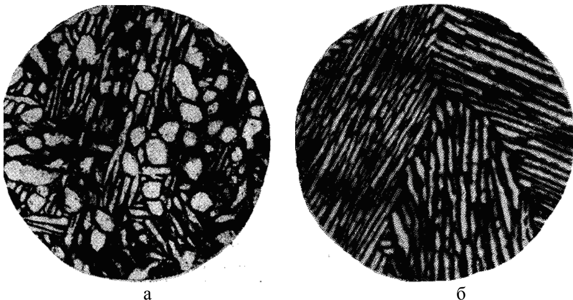
Рис. 18.19. Мікроструктура сплаву ВТ6 після нагрівання та повільного охолодження (збільшення в 500 разів) [25]:
