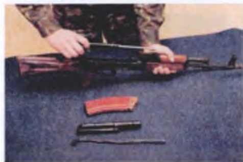
Іл. 12.9. Відокремлення затворної рами із затвором
