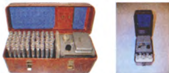
Іл. 34.5. Комплекти індивідуальних дозиметрів ДП-22В і ДП-24
