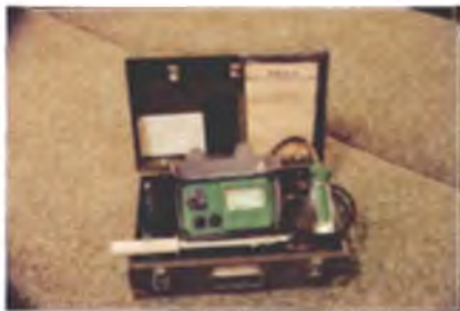
Іл. 34.4. Вимірювач потужності доз ІМД-5
