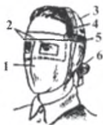
Іл. 36.1. Протишолова тканинна маска ПТМ-1: 1 — корпус маски; 2 — оглядові отвори; 3 — кріплення; 4 — гумова тасьма; 5 — поперечна гумова смужка; 6 — зав'язки
