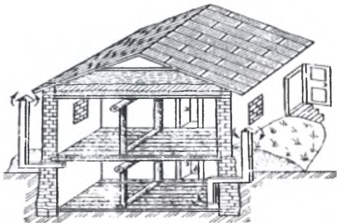
Іл. 35.3. Протирадіаційне укриття в підвалі кам'яної будівлі
