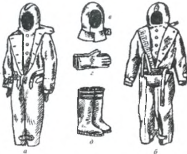
Іл. 37.2. Засоби захисту шкіри: а — захисний комбінезон; б — захисний костюм; в — підшоломник; г — гумові рукавиці; д — гумові чоботи
