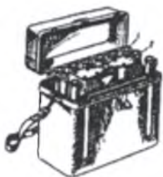
Іл. 34.7. Комплект ІД-1: 1 — індивідуальний дозиметр; 2 — зарядний пристрій
