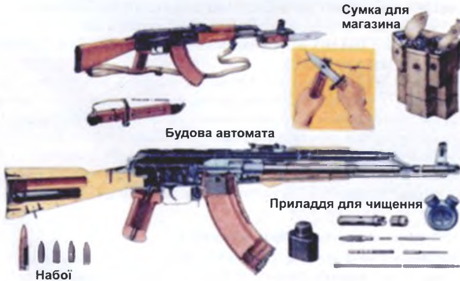
Іл. 12.1. Автомат Калашнікова: загальний вигляд, будова, набой, сумка для магазина, приладдя для чищення
