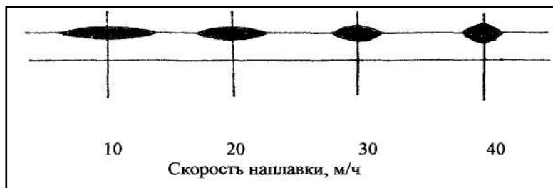
Рисунок 3.2 – Влияние скорости наплавки на размеры и форму валика металла
