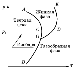
Рис. 1.36 Кривые фазовых переходов вещества в pT -координатах
