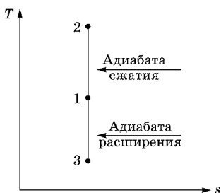
Рис. 1.15 Адиабатный процесс в Ts -координатах
