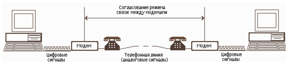
Рис. 7. Схема реализации модемной связи
