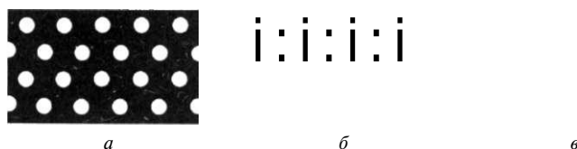
Рис. 3.37. Типи масок у моніторах: а - тіньова маска; б - щільна маска; в - апертурні ґрати
