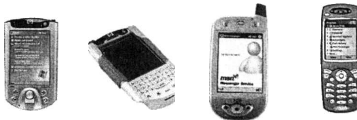
Рис. 4.9. Ручні і кишенькові комп'ютери: а - ручний комп'ютер; б - кишеньковий комп'ютер без клавіатури; в - кишеньковий комп'ютер із клавіатурою; г - кишеньковий комп'ютер з убудованим телефоном; д - «інтелектуальний» телефон
