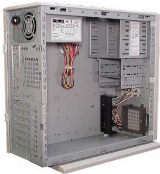
Рис. 1.42. Блок живлення розташований "горизонтально"
