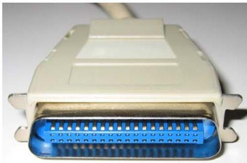
**Рис. 15.7. Кабельный 36-контактный разъём для подключения внешнего устройства (IEEE 1284-B)**
