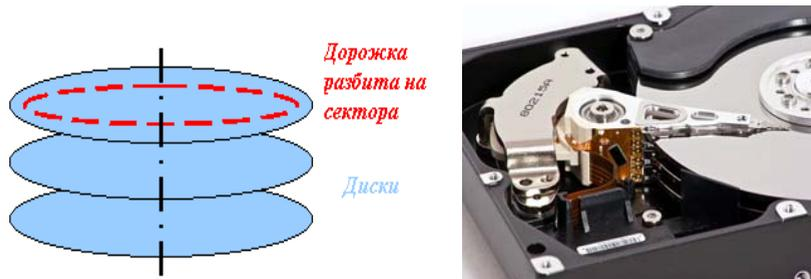
**Рис. 11.6. Схема жесткого диска**
