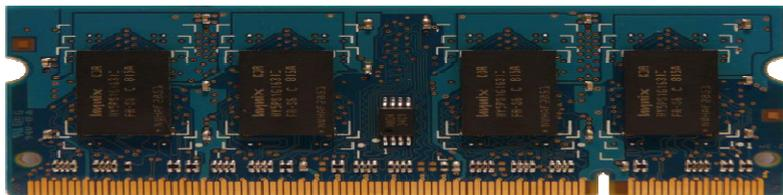
**Рис. 11.14. Модуль 1GB DDR2 в 204-контактном корпусе SO-DIMM**
