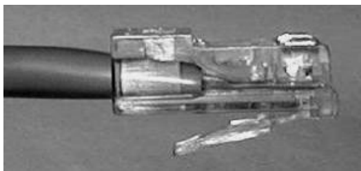
Рис. 3.6.4. Правильне з'єднання кабелю UTP з конектором RJ-45
