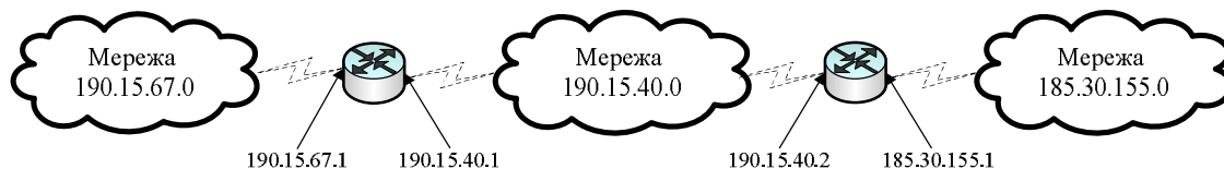
Рис. 3.5.2. Приклад нераціонального використання простору IP-адрес
