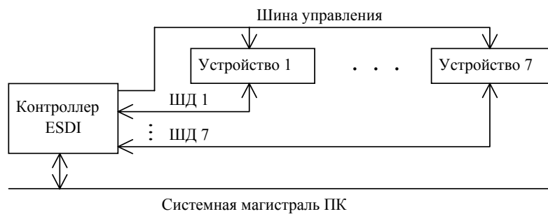
Рис. 3.14. Схема сопряжения контроллера с внешними устройствами в интерфейсе ESDI
