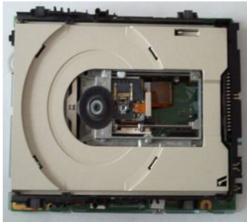
Рис. 25. Привод CD-ROM із знятим корпусом і лотком для компакт-дисків
