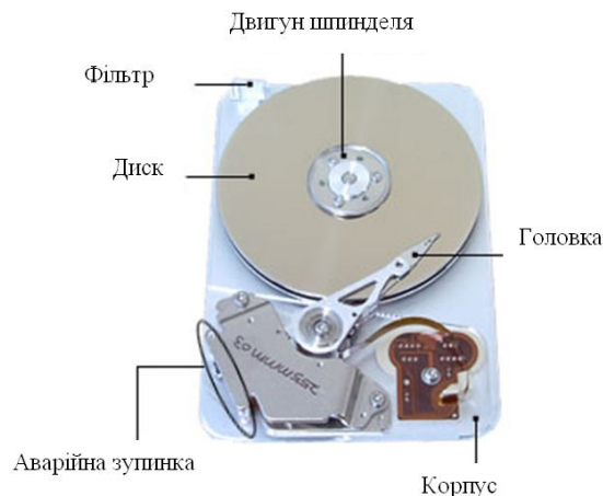
Рис. 18. Внутрішня будова жорсткого диска
