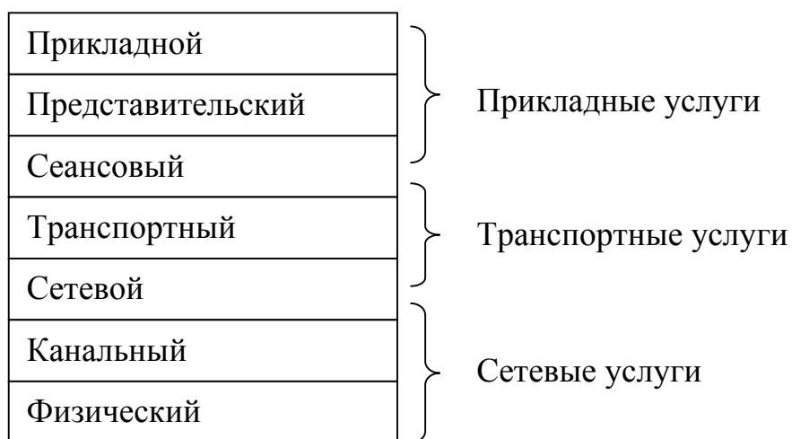
Рис. 3.1. Уровни модели OSI и типы протоколов
