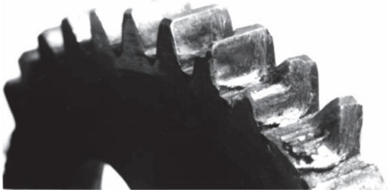
*Рис. 8.24. Пластическая деформация зубьев*
