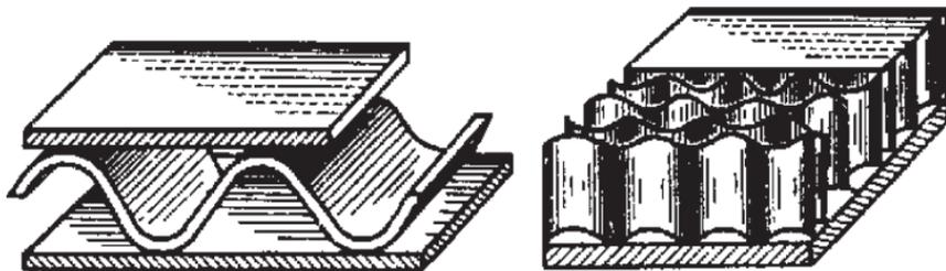
*Рис. 4.2. Самолетная обшивка из тонких стальных листов с сотовым промежуточным заполнением*
