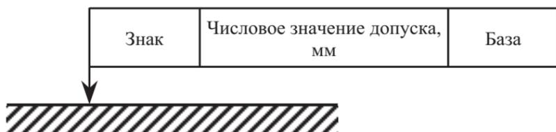
Рис. 18. Схема указания допусков формы и расположения поверхностей
