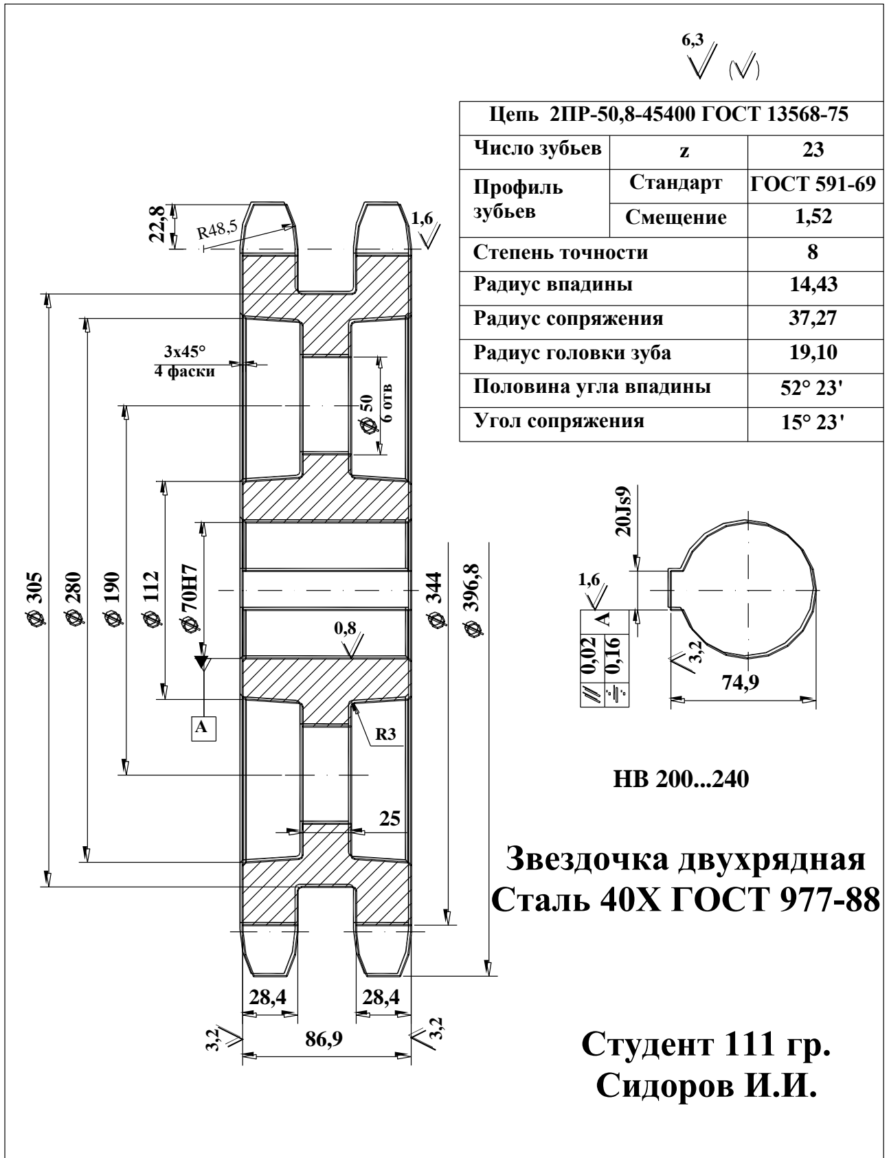
Рис. 6.5. Эскиз звездочки
