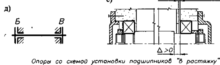
Рис. 8.2.1. Схемы осевого фиксирования валов
