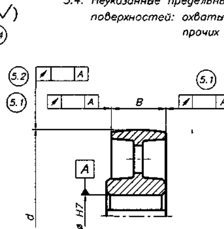
Рис. 2.5.6. Отклонения формы и расположения поверхностей шкивов
