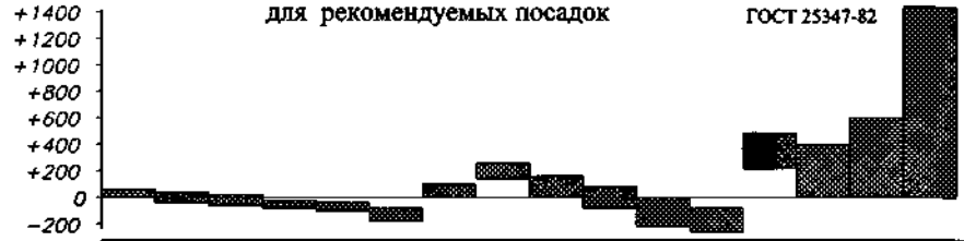
Табл. 17.3.5. Предельные отклонения и поля допусков ОТВЕРСТИЙ, мкм ГОСТ 25347-82 для рекомендуемых посадок
