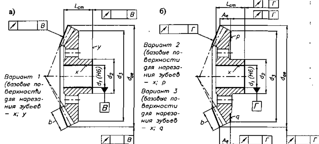
Рис. 11.3.23. Допуски формы и расположения поверхностей для вариантов 1, 2, 3 выполнения заготовок конического колеса при различных базовых поверхностях для нарезания зубьев
