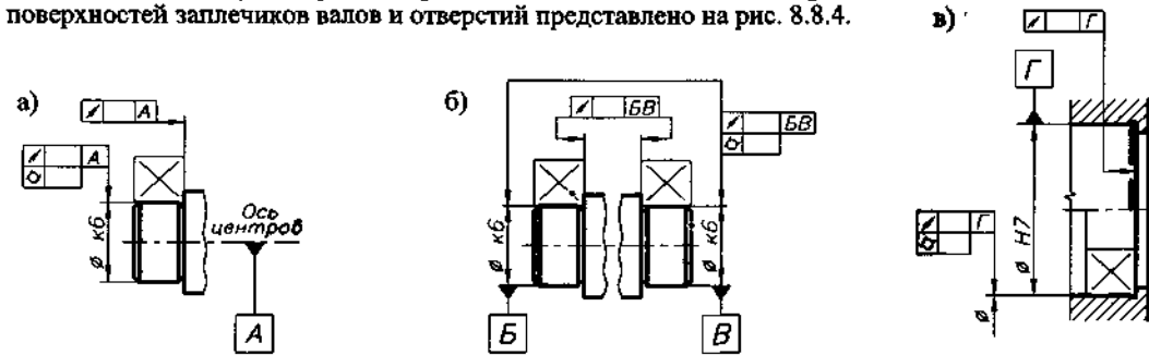
Рис. 8.8.4. Обозначение на чертежах допусков формы и расположения поверхностей установки подшипников: а), б) для вала, если базой является ось; в) для отверстия корпуса, если базой является ось
