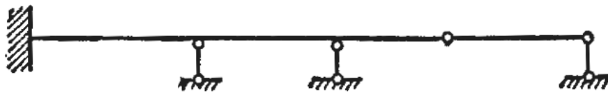
Рис. 17.3. К определению степени статической неопределимости балки
