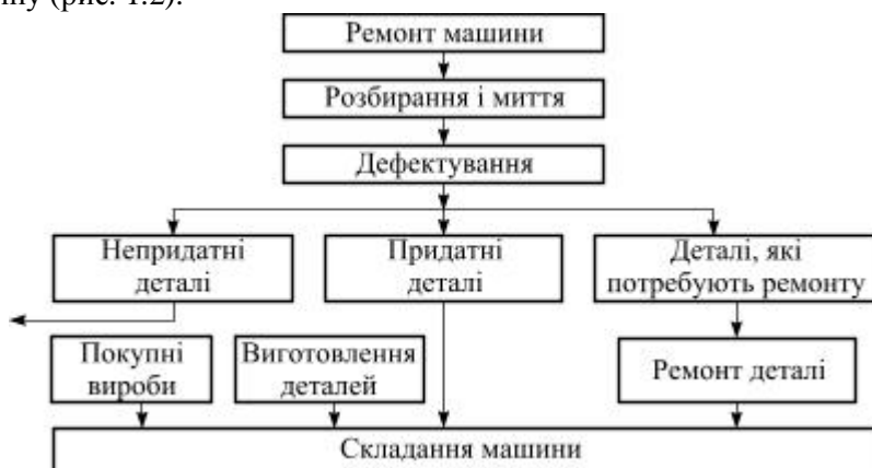
Рис. 1.2. Схема ремонту машин індивідуальним (бригадним) методом
