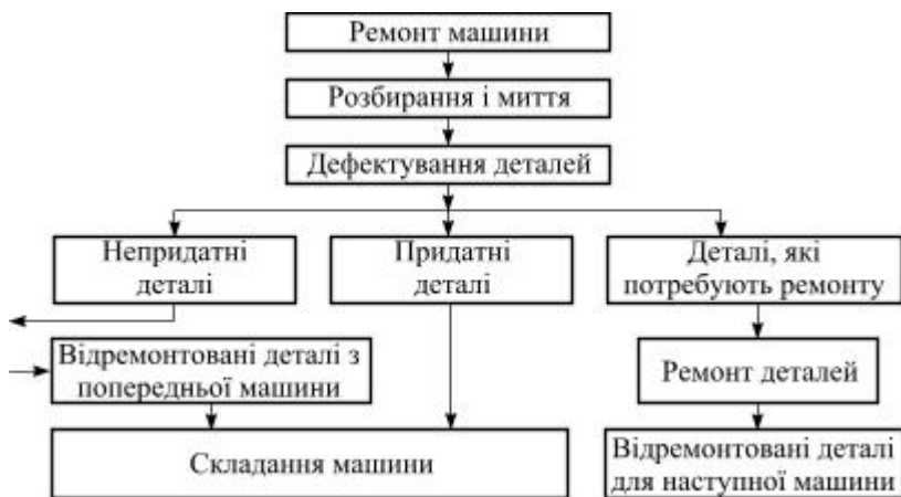
Рис. 1.3. Схема ремонту машин агрегатним методом
