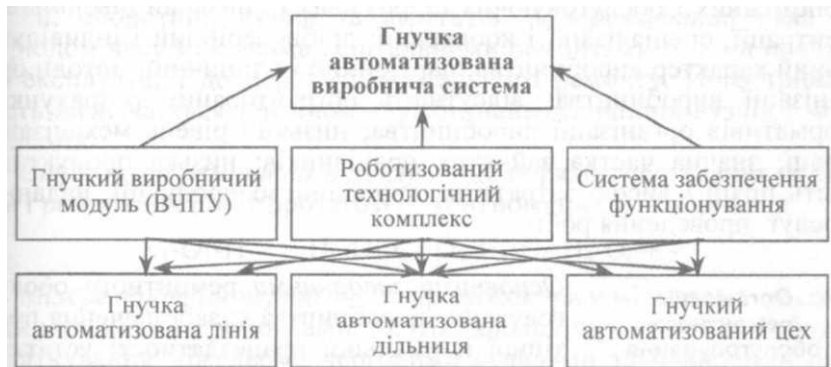
Рис. 14.3. структура гнучкої автоматизованої виробничої системи Гнучкі автоматизовані системи -це стратегічний напрям розвитку техніки та організації виробництва.
