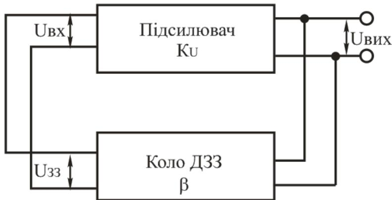
Рисунок 11.1 – Структурна схема генератора синусоїдальних коливань
