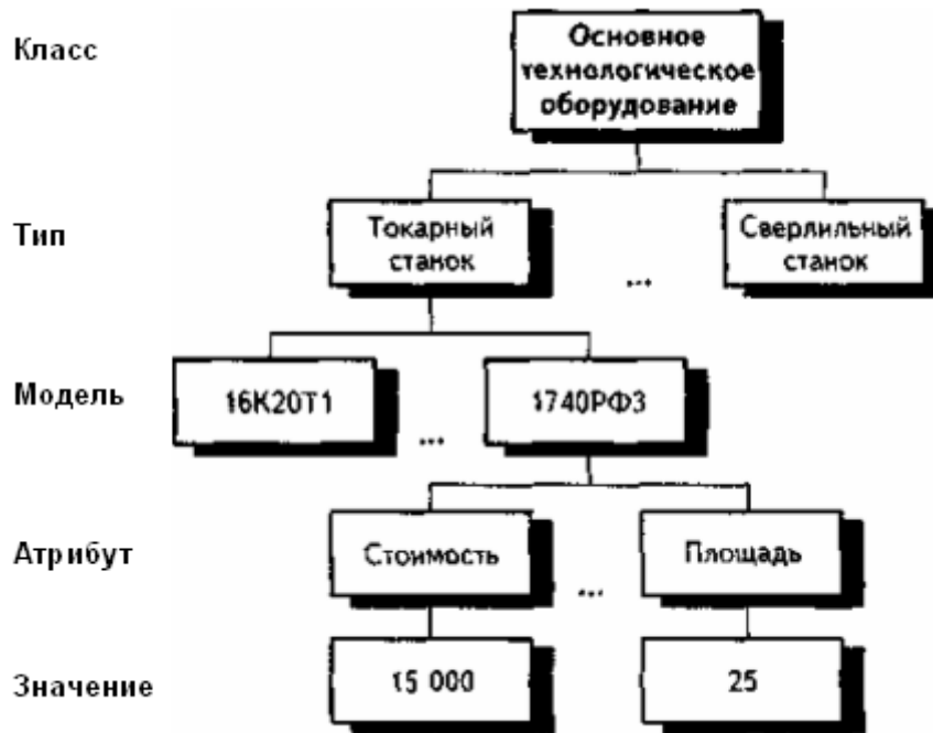
Рис. VIII. Уровни детализации описания объекта «Основное технологическое оборудование»
