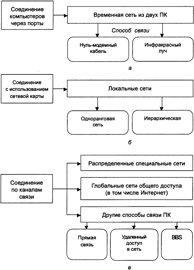
Рис. 9.1. Способы соединения компьютеров и виды сетей: а – временная сеть; б – локальные сети; в – сети, организованные с помощью каналов связи
