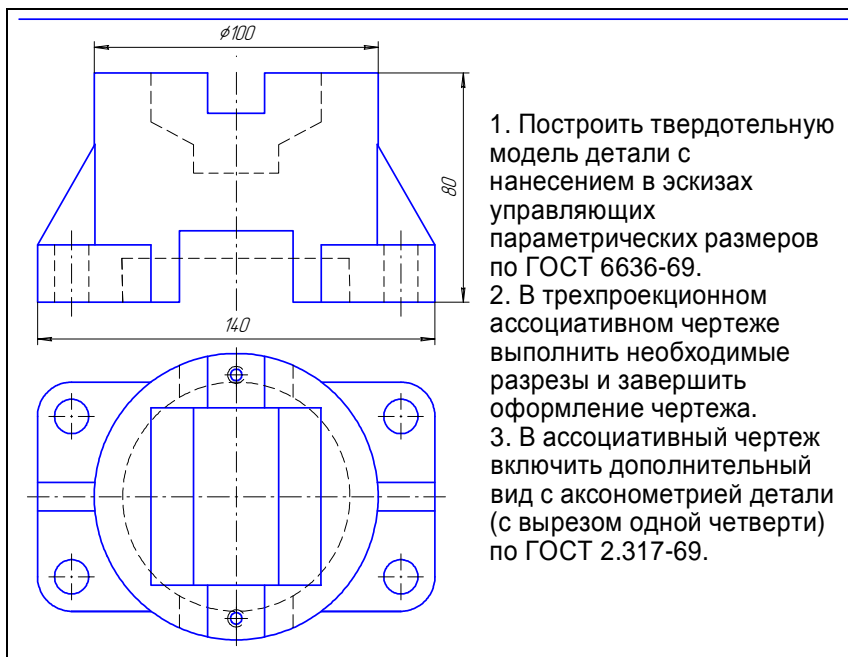
Рис. 6.27. Исходные данные для создания модели и чертежа корпуса
