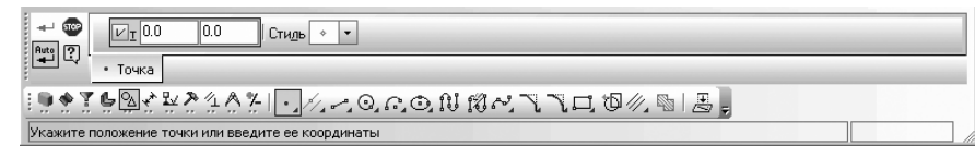
Рис. 3.74. Панель свойств: Точка, компактная панель и Строка сообщений
