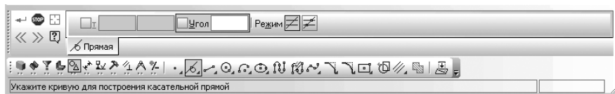
Рис. 2.95. Фрагмент главного окна системы: Панель свойств: Касательная прямая через точку на кривой , Компактная панель и Строка сообщений
