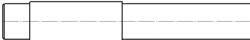
Рис. 4.99. Результат изображения линий ступеней и фасок вала
