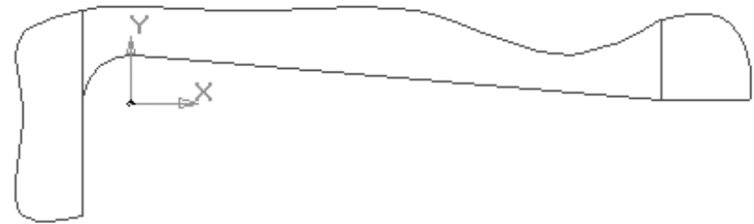
Рис. 2.59. Вид канавки вала в месте сопряжения двух ступеней вала
