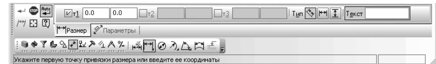
Рис. 2.46. Фрагмент главного окна системы: Панель свойств: Линейный размер с открытой вкладкой Размер , Компактная панель и Строка сообщений
