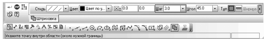
Рис. 4.40. Панель свойств: Штриховка , Компактная панель и Строка состояния
