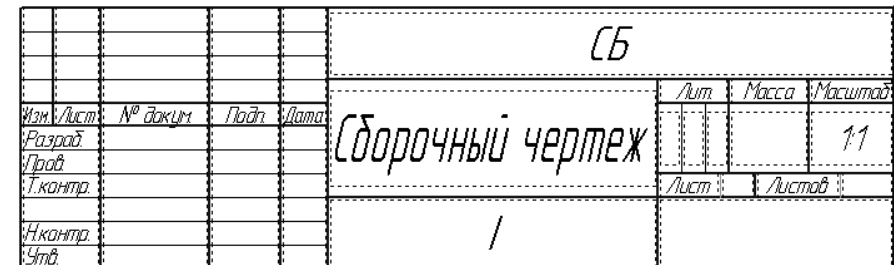
Рис. 5.49. Пример вставки выбранного кода СБ в основную надпись
