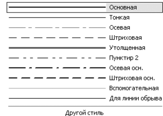
Рис. 2.40. Раскрывшийся список Стиль в Панели свойств: Отрезок
