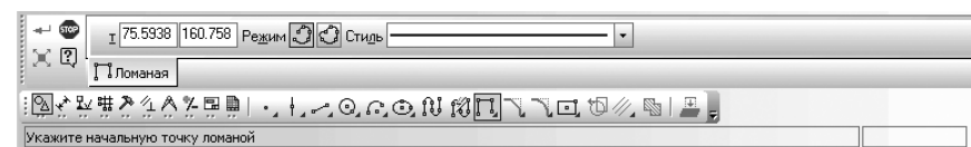
Рис. 4.66. Панель свойств: Ломаная, Компактная панель и Строка состояния
