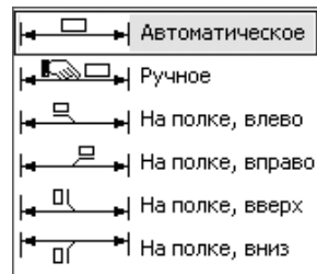
Рис. 3.27. Список возможных представлений надписи на размерной линии
