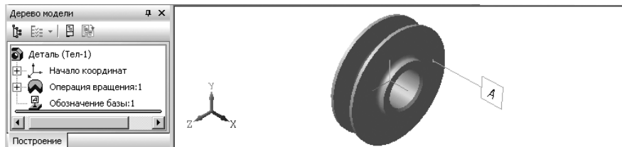
Рис. 3.148. Результат простановки знака базы нажмите клавишу Esc для завершения простановки знака базы
