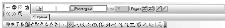
Рис. 2.61. Фрагмент главного окна системы: Панель свойств: Параллельная прямая и Компактная панель с активной кнопкой – Параллельная прямая
