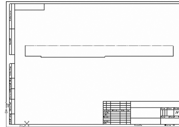
Рис. 4.97. Возможное расположение эскиза половины контура вала на форматке А3 с горизонтальной ориентацией
