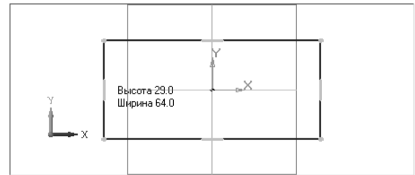
Рис. 2.78. Эскиз прямоугольника, построенного по центру и вершине
