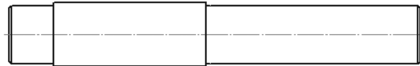
Рис. 4.100. Результат продления осевой линии за торцы вала
