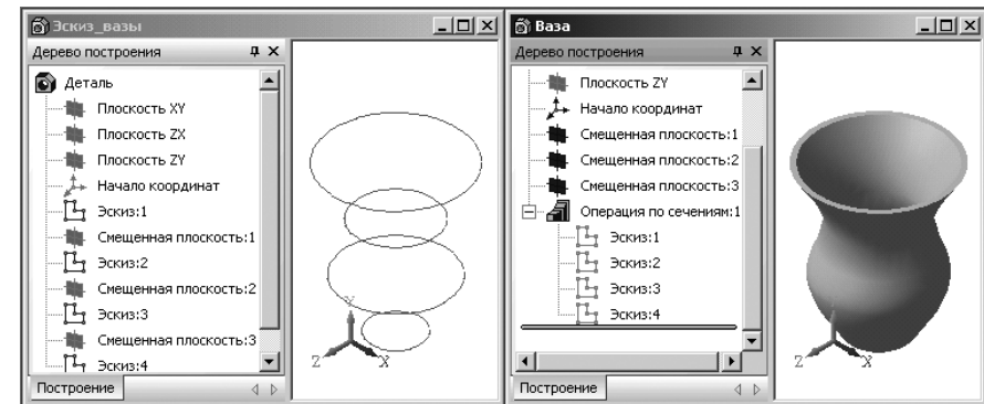
Рис. 1.54. Пример эскизов сечений и элемента перемещения по сечениям
