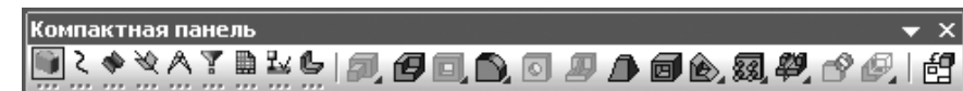
Рис. 1.33. Компактная панель в режиме создания и редактирования детали в плавающем состоянии с нажатой кнопкой-переключателем Редактирование детали
