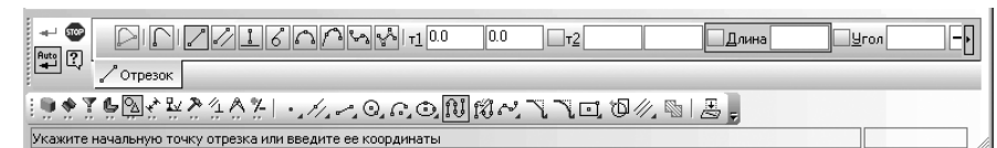
Рис. 2.43. Фрагмент главного окна системы: Панель свойств: Непрерывный ввод объектов с открытой вкладкой Отрезок , Компактная панель и Строка сообщений
