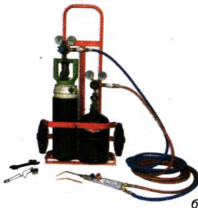
Мал. 36. Для ацетиленокисневого зварювання(а) використовують спеціальне обладнання (б)
