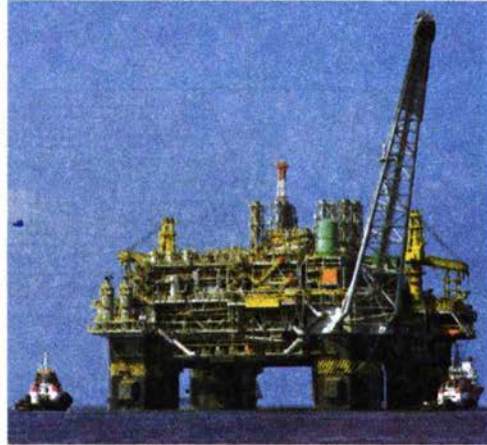
Мал. 49. Видобування нафти з платформи в морі
