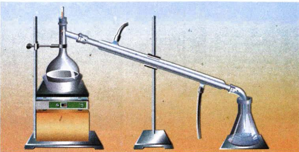
Мал. 50. Перегонка нафти в лабораторії
