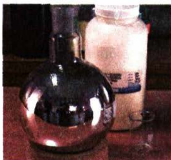
Мал. 73. У результаті реакції «срібного дзеркала» срібло утворює осад на стінках колби
