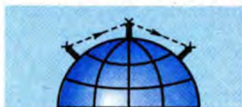
Мал. 3.23. У системах радіозв'язку на ультракоротких хвилях застосовують лінії з ретрансляторами
