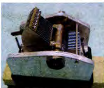
Мал. 1.35. Конденсатор змінної електроємності з повітряним діелектриком
