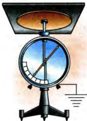
Мал. 1.16. Піднесення діелектричної пластини до зарядженої пластини зменшує покази стрілки електрометра
