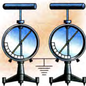
Мал. 1.12. Металеві циліндри зарядилися в електричному полі різнойменно
