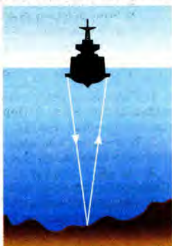
Мал. 3.15. Схема, яка пояснює дію ехолоту
