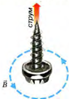
Мал. 2.7. Визначення напрямку магнітної індукції поля прямого провідника зі струмом за допомогою правого гвинта (свердлика)
