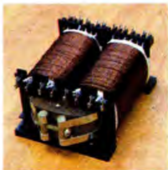
Мал. 2.51. Трансформатор змінного струму з двома обмотками
