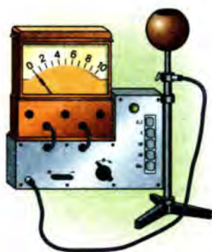
Мал. 1.6. Лабораторний вимірювач напруженості електричного поля
