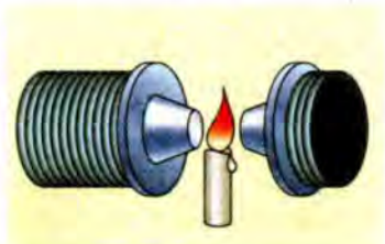
Мал. 2.19. Полум'я свічки виштовхується з магнітного поля
