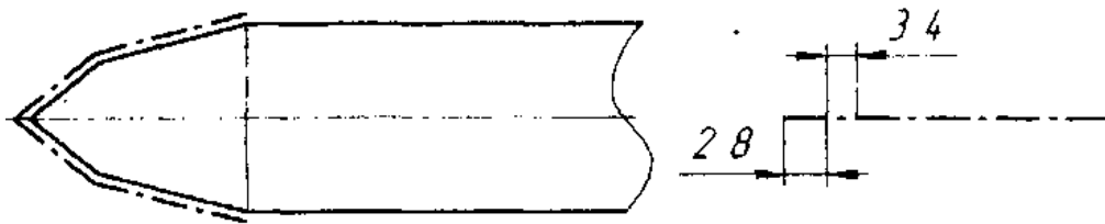
Рис. 4.41 – Позначення поверхні різця, що підлягає термічній обробці
