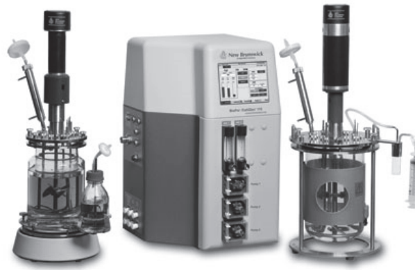
Рис. 12. Лабораторний ферментер для глибинного культивування аеробних мікроорганізмів
