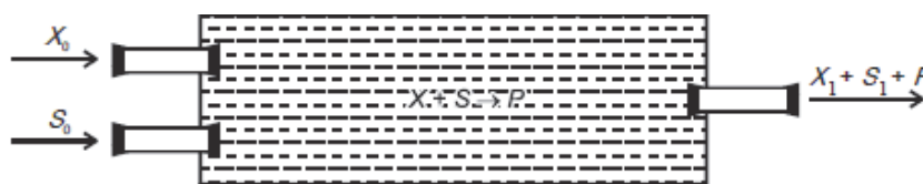
Рис.23. Схема тубулярного біореактору повного витіснення:
