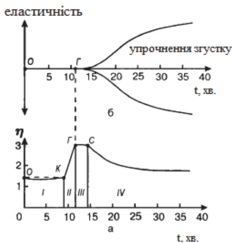
Рис.38. Реограма (а) та еластограма (б) процесу сичужного згортання молока: (I – індукційний період, II – стадія флокуляції, III – метастабільна рівновага, IV – синеретична стадія; O – внесення сичужного ферменту, K – початок явної коагуляції, Г – гель-точка, С – початок синерезиса
