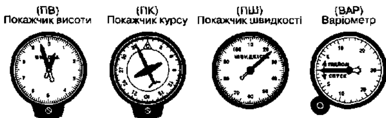
Р и с. 21 Приклади стрілкової індикації. Загальний вигляд пілотажних приладів
