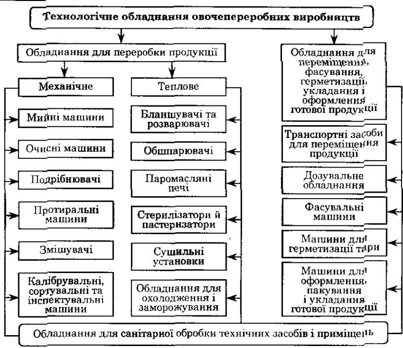
Рис. 2.1. Класифікація технологічного обладнання для переробки плодовоовочевої продукції
