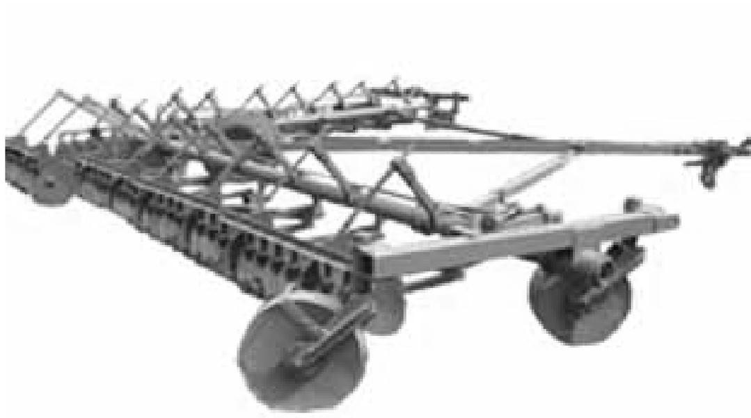
Рис. 22. Луцильник дисковий гідрофікований ЛДГ-10А.
