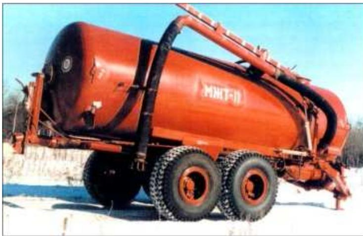
Рис. 30. Машина для внесення рідких органічних добрив МЖТ-11.
