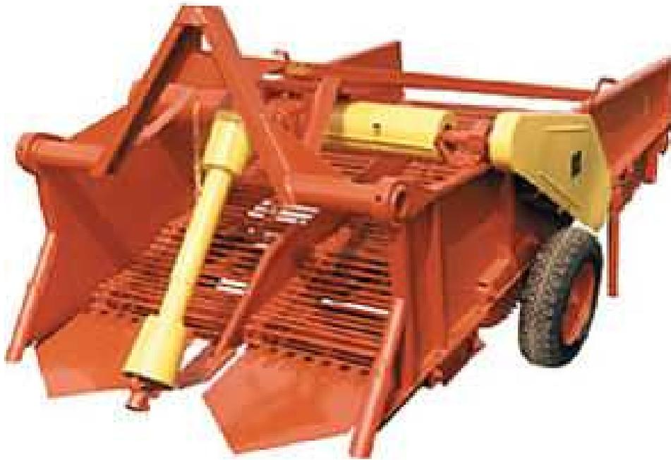
Рис. 85. Картоплекопач тракторний навісний двохрядний КТН-2В
