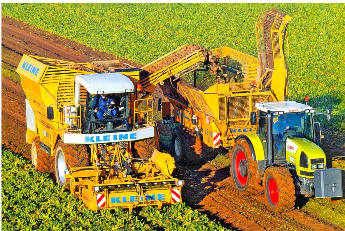
Рис. 84. Бурякозбиральний комбайн SF 10-2 фірми KLEINE
