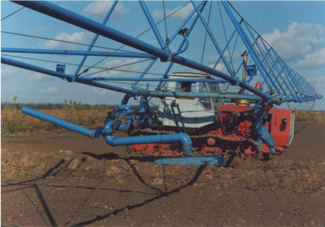
Рис. 73. Двоконсольний дощувальний агрегат ДДА-100МА-1.
