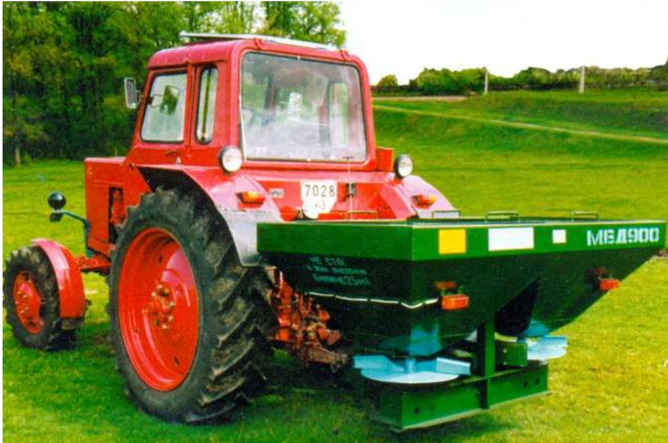
Рис.28 Машина для внесення мінеральних добрив МВД-900
