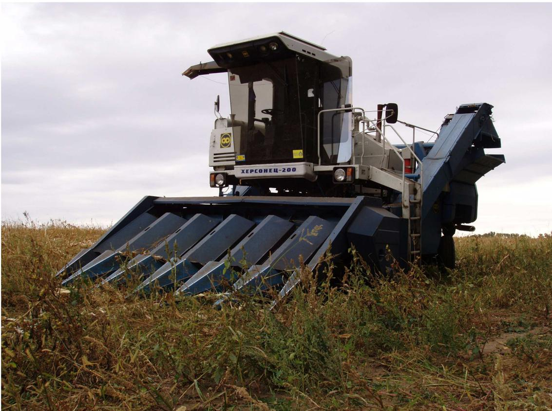
Рис. 80. Комбайн самохідний кукурудзозбиральний КСКУ-6АС-18
