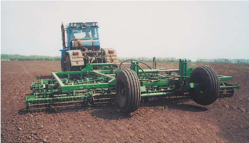
Рис. 18. Культиватор комбінований напівпричіпний ККП-6 «Кардинал»
