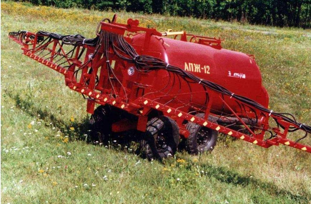
Рис. 74. Машина для внесення рідких мінеральних добрив АПЖ-12.
