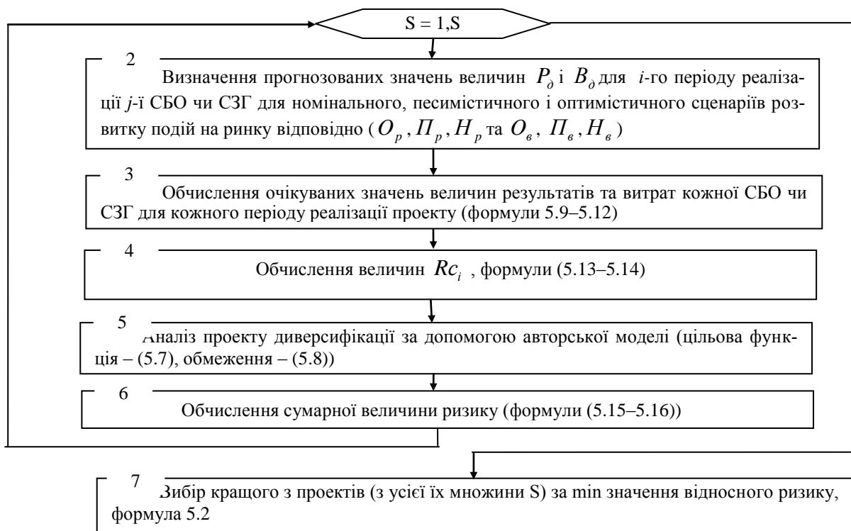
Рис. 5.15. Укрупнена блок-схема алгоритму вибору оптимального варіанту стратегій диверсифікації
