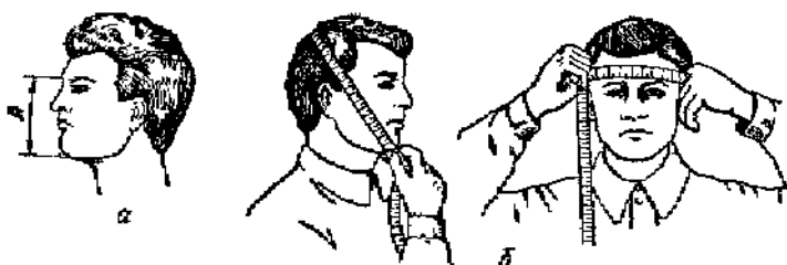
33. Схема вимірювання розмірів обличчя і голови для вибору напівмаски респіратера (а) і шолом-маски протигазу (б).
