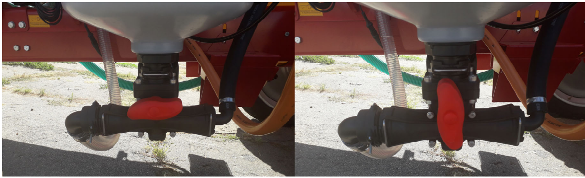
Рисунок 8. Положення важеля для закачування води в міксер з великого бака (а) і під час роботи з «пістолетом» або викачування води в основний бак (б)
