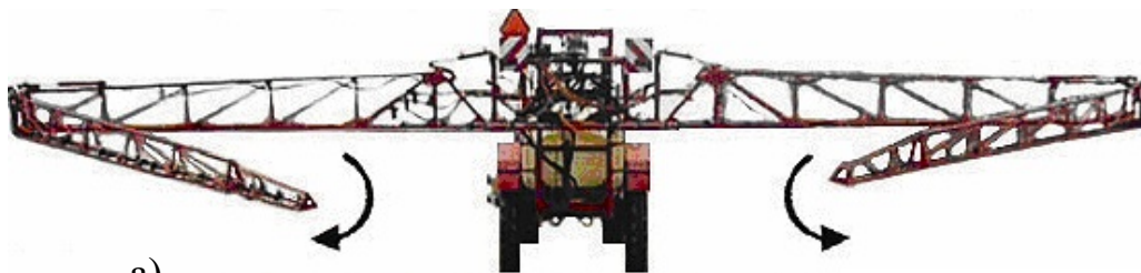
Рисунок 4. Положення штанг секцій (а) і тумблера пульта керування «Bravo 180» (б) за четвертого кроку розкладання секцій обприскувача TETIS 24
