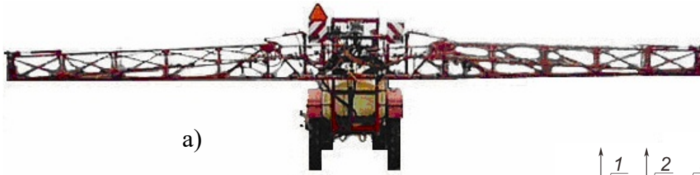
Рисунок 3. Положення штанг секцій (а) і тумблера пульта керування «Bravo 180» (б) за третього кроку розкладання секцій обприскувача TETIS 24
