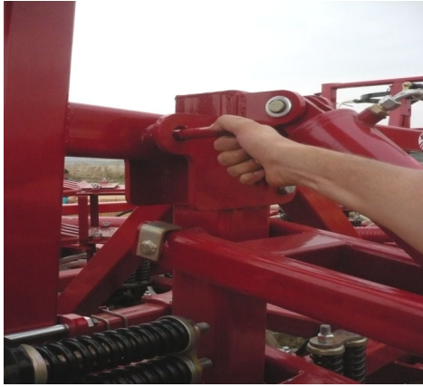
Рисунок 16. Фіксування секції в транспортному положенні
