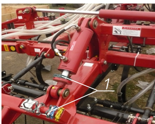
Рисунок 14. Місце встановлення упорів регулювання глибини в задній частині рами
