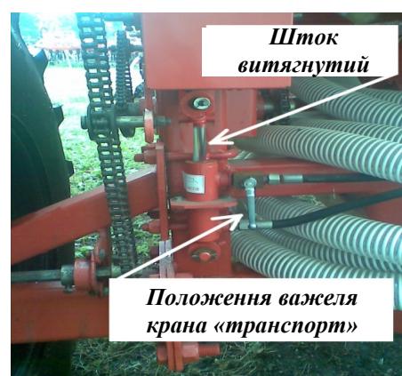
Рисунок 15. Кран керування приводом у транспортному положенні
