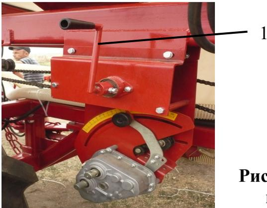
**Рисунок 6. Важіль для прокручування приводу висівних апаратів сівалки-культиватора**
