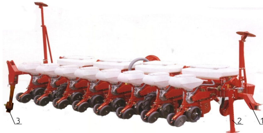
Рис. 4.3 - Зберігання сівалки без використання транспортувального пристрою: 1 – сниця; 2 і 3 – опори
