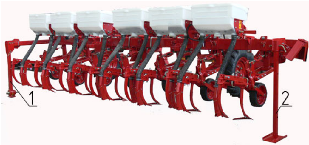
Рисунок 4. Забезпечення стійкості культиватора
