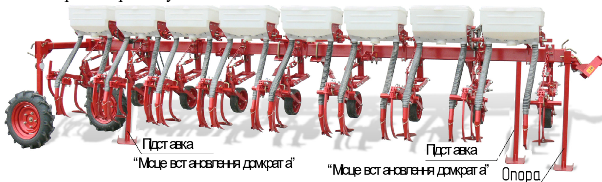
Рисунок 6. Встановлення культиватора на опору і підставки
