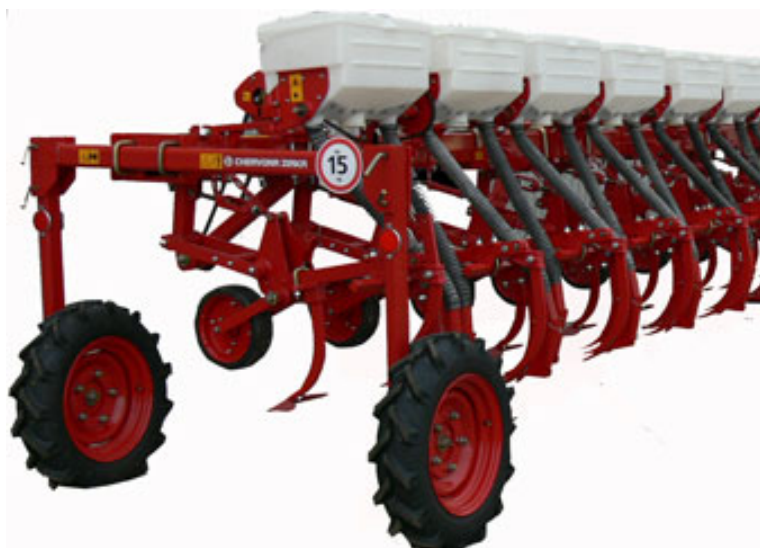
Рисунок 2. Встановлення знаку обмеження швидкості на культиваторі
