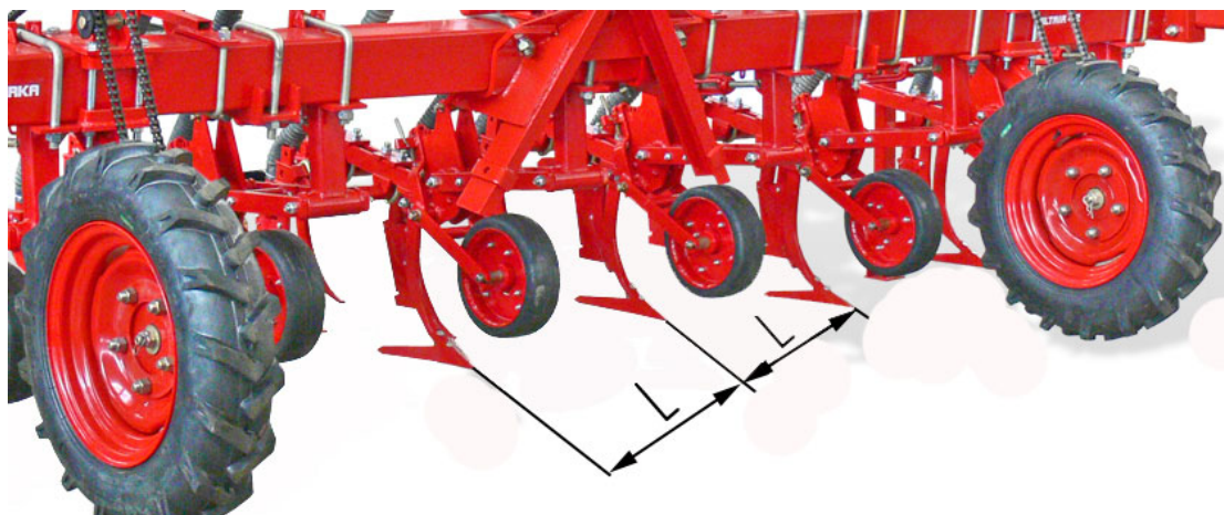
Рисунок 5. Перевірка правильності розстановки секцій робочих органів
