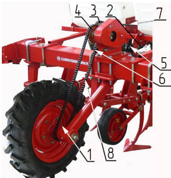
Рисунок 17. Привод опорно-приводного колеса
