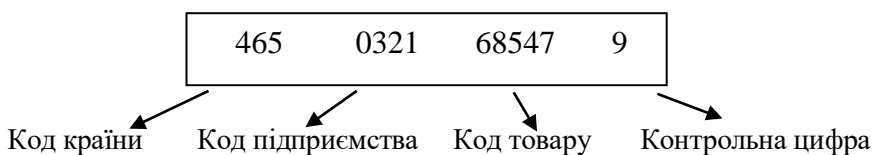
Рис. 5.5. Структура коду EAN-13
