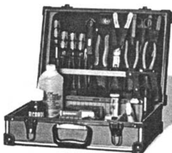
Рис. 7.23. Набор инструментов для монтажа оптического кабеля
