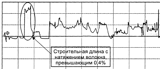
Рис. 7.22. Рефлектограмма элементарного кабельного участка (ЭКУ) длиной 179 км, измеренная с помощью бриллюэновского рефлектометра
