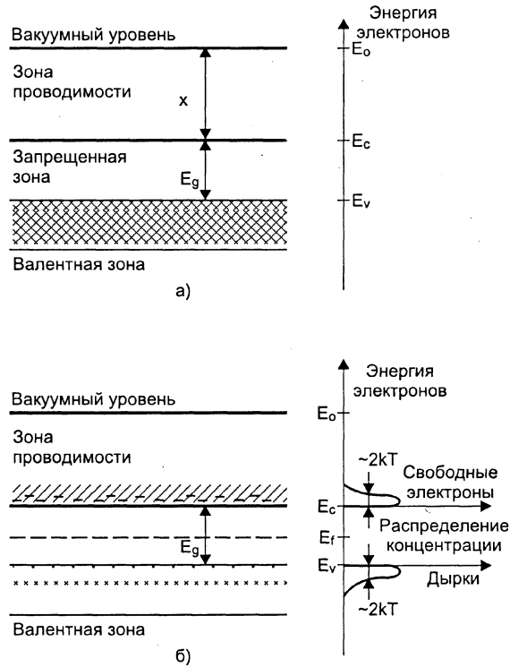
Рис. 9.13. Схема электронных энергетических уровней собственного полупроводника: а — валентная зона полностью заселена; б — некоторая концентрация электронов в зоне проводимости при равной концентрации дырок в валентной зоне (концентрация электронов в зоне проводимости — уровень Ферми)
